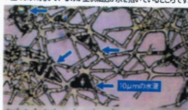
【特徴】同時に10μmの水滴を吸放出し、室内の湿度をコントロールします。微細で複雑な構造の星状細胞が有害物質を吸着し、無害なものにします。
